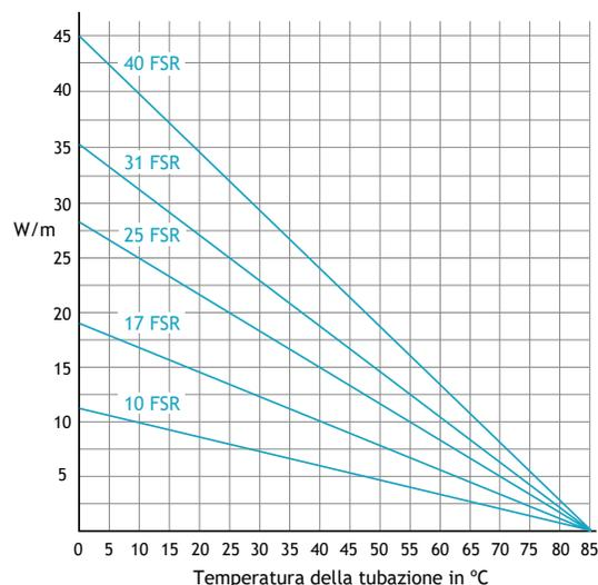
Il grafico mostra la potenza nominale fornita con alimentazione a 230V c.a e il cavo installato su una tubazione di metallo opportunamente coibentata e dimensionato secondo le norme IEC 62395 e IEC 60079-30.
