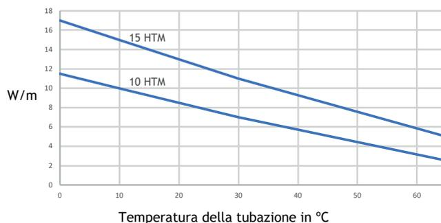
Il grafico mostra la potenza nominale fornita con alimentazione a 230V c.a e il cavo installato su una tubazione di metallo opportunamente coibentata e dimensionato secondo le norme IEC 62395 e IEC 60079-30.
